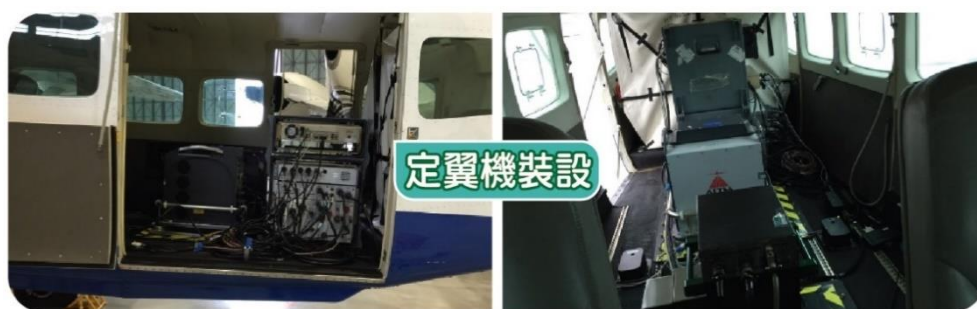
圖 4-6、機載光達和高光譜裝機現況
