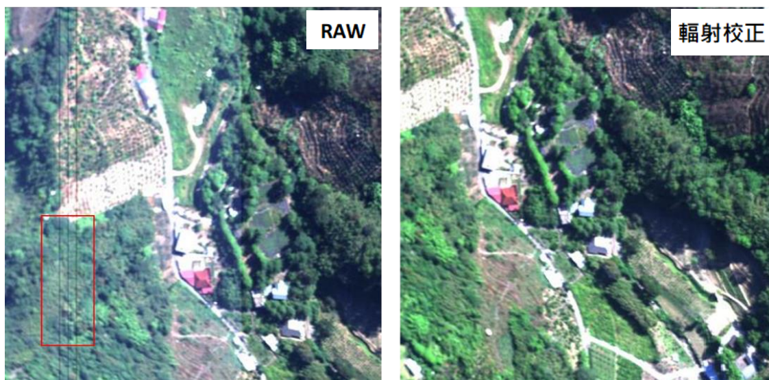
圖 4-13、輻射校正前(左)和後(右)影像對照(以 109 年成果為例)
