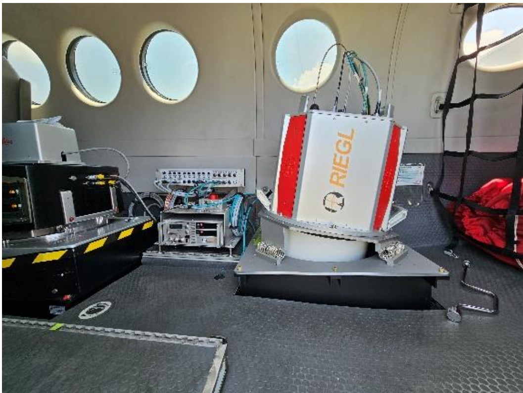
▲ 空載光達掃描儀(RIEGL VQ-1560 II-S)完成安裝
