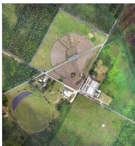
▲翼龍無人機航拍成果-花蓮大農大富（拍攝約 16 平方公里，解析度約 6 公分）
