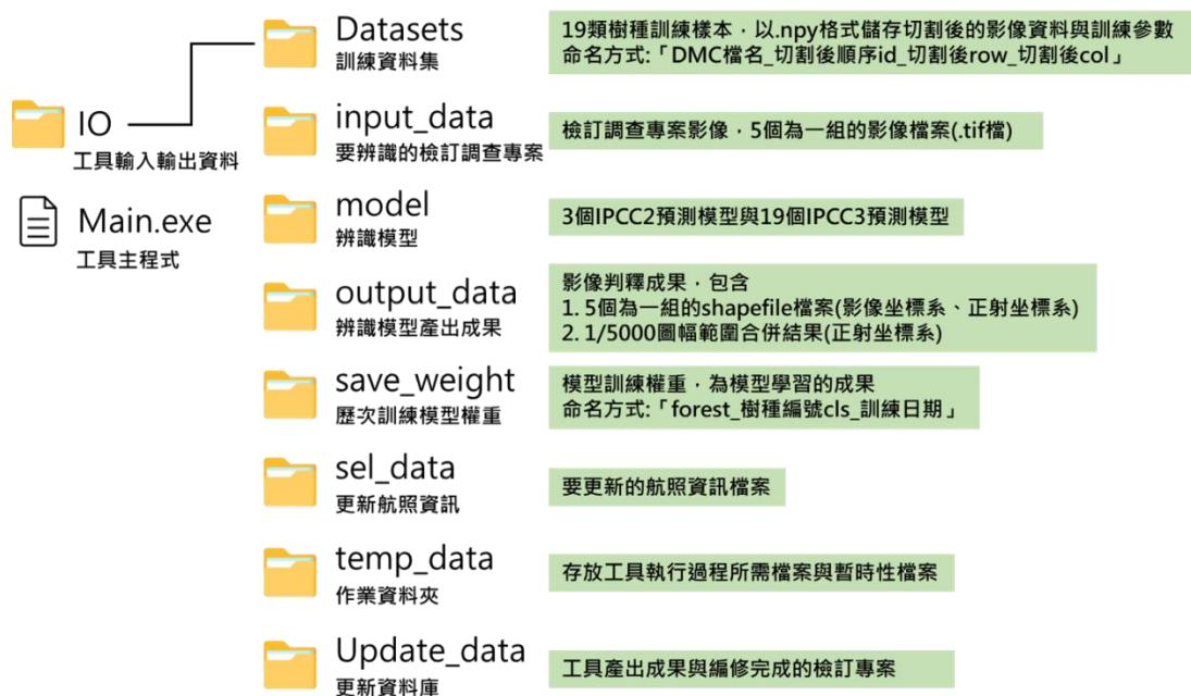
圖 4-6 本計畫 111 年度開發工具之後端程式架構清單
