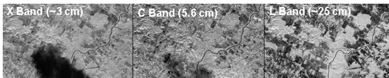
圖 2-3.2 不同波段雷達影像在雲與水氣干擾的情況(資料修改自： https://earth.esa.int/c/document_library/get_file?folderId=226458&name=DLFE-2124.pdf 第 5 頁)
