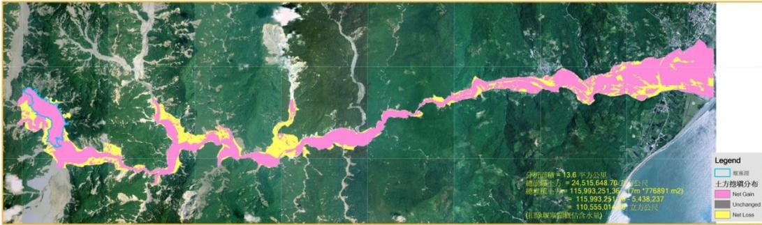
圖 23、太麻里溪災前災後河道地形變化及挖填方圖
