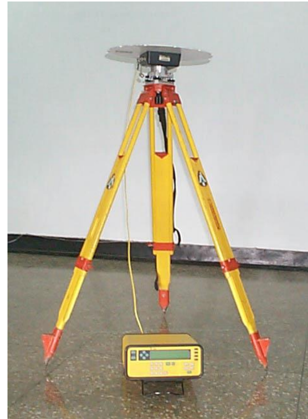
▲ 衛星定位儀架設於三角架上
