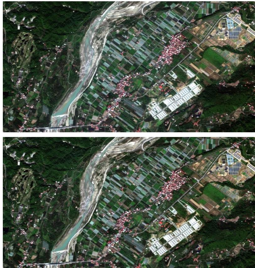
圖 14 FLAASH 大氣校正處理後之 WV2 影像(以波段 5, 3, 2 進行 RGB 組合，上圖為處理前，下圖為處理後)
